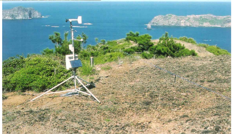
写真 3 初寝山観測点に設置した総合気象観測装置
