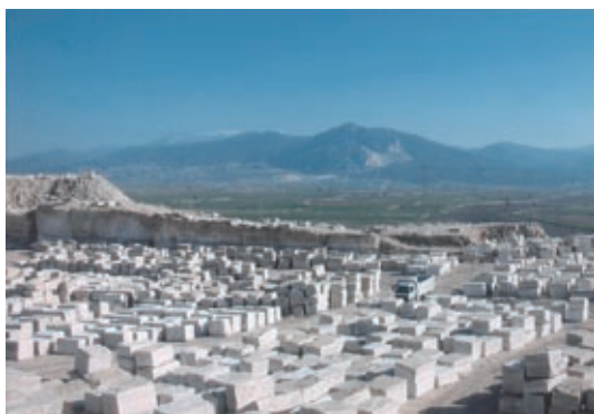
図 5 トラバーチンの採石場 (コジャバス)。 地質時代は第四紀。碎石会社はテムメール社。チェーンソーで3mの大きさに切っている。
