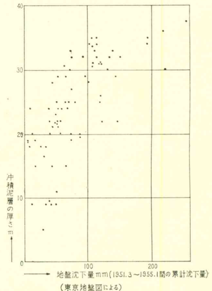
図2.15 地盤沈下量と沖積泥層の厚さの関係 ——東京下町の場合——
